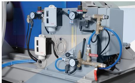
Estas máquinas poseen un sistema de enfriamiento automático que monitorea la temperatura del material durante el proceso y garantiza que la temperatura se mantenga al nivel deseado.
