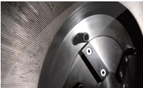
Los Pulverizadores PM de Zerma pueden equiparse con discos de una pieza o segmentados, ambos están hechos de acero de alta calidad y resistencia.
